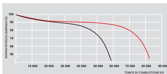
Il ciclo di commutazione 12 h viene definito come il momento in cui il 10% delle lampade di un impianto sono guaste. L'alterazione lumen, in quel momento, viene indicata con un valore inferiore al 10%.
