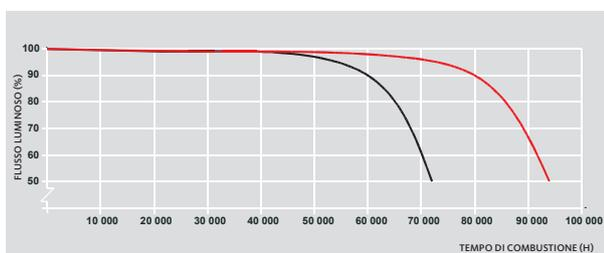
La durata operativa viene raggiunta quando il livello di illuminazione di un sistema si abbassa all'80% del valore iniziale, pari a 100 h. La durata operativa si calcola in base al tasso di difetto della lampada ed all'alterazione lumen in conformità a IEC/EN 60081 sulla base di un ciclo di commutazione di 3 ore.
