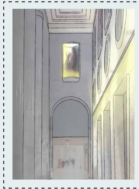
Il progetto studiato da Aura Light Italia è stato quello di sottolineare la struttura dell'edificio, in un equilibrio fra linee orizzontali e verticali. La verticalità è sottolineata dall'effetto delle lampade a parete uplight, che corrono parallele lungo le coppie di colonne, al terzo piano.
