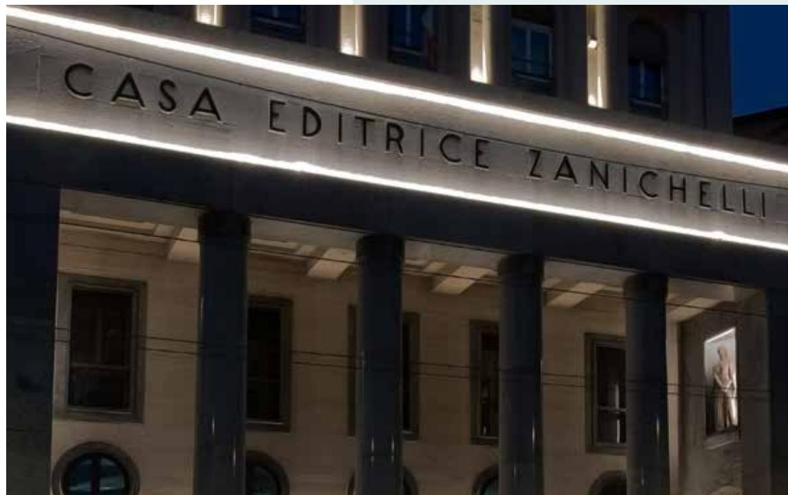
La parte centrale del progetto è stata quella di restituire la giusta importanza alla scritta "Casa Editrice Zanichelli", incorniciandola con due profili Omnia 1. Grazie alla loro dimensione ridotta è stato possibile posizionare all'interno della scanalatura del cappello in marmo e sullo spessore generato dalla cornice delle colonne.
