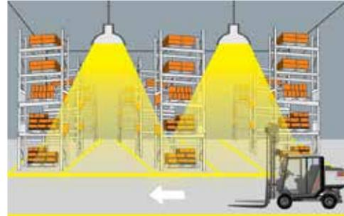
Con insufficiente livello di illuminamento, il sensore accende la lampada se rivela movimento.
