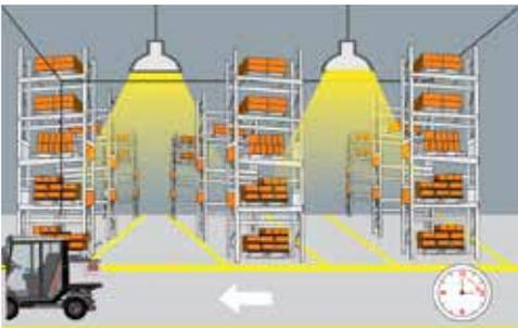
Dopo un dato ritardo (Hold time) il sensore dimmerà la lampada fino ad un dato livello di illuminamento se non viene rilevato movimento.
