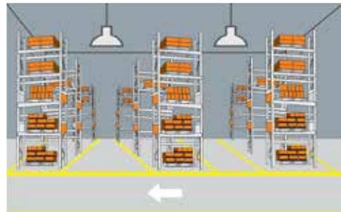
Dopo un ulteriore intervallo di tempo il sensore spegne la lampada se non viene rilevato movimento nell'area.
